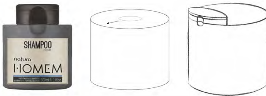
Figura 11: Embalagem do Modelo 1 com as dimensões otimizadas e alteração na posição do flip de abertura
